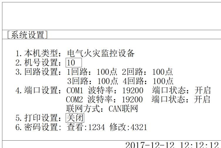
系统设置内可更改监控设备的机号设置（1-64）；回路设置（根据实际使用点数设置，优先设置1回路，如果1回路没有设置则其他3个回路都无法设置值，每个回路最多127点）；端口设置：波特率（9600、19200二档可选，默认COM1:19200, COM2: 19200），端口状态（开启、关闭）；打印设置（开启，关闭）；查看及修改密码（4位）。通过方向键来选择需要更改的选项，并按‘确认’键进入更改，输入或选择需要的值，按‘确认’键自动退出（如下图），所有选项
