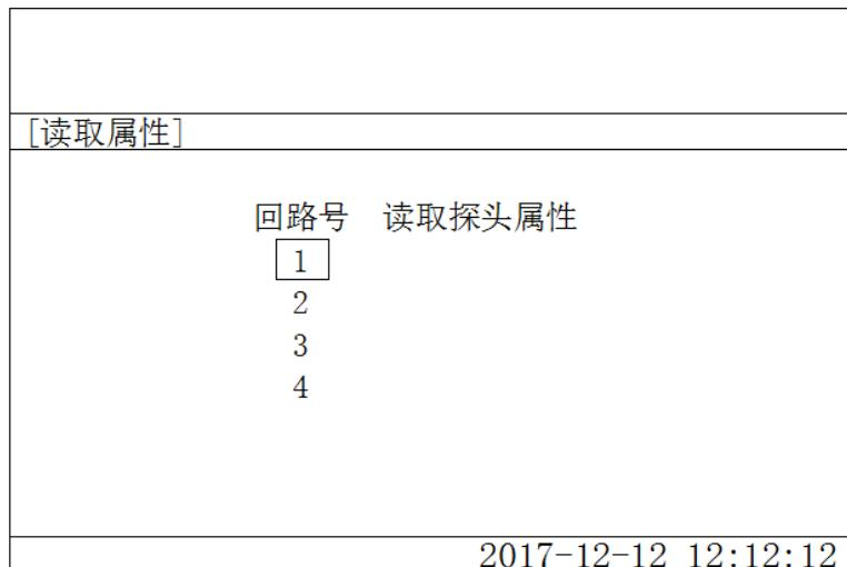
选择回路号按‘确认’后，会自动读取这个回路内的所有探测器类型，如与属性设置内类型不相符合，会自动更改属性设置内的类型，如有更改内容需手动更改属性设置内的设置。
