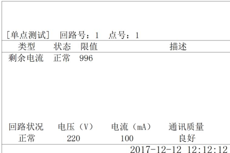
单点测试可监控接入本机的每个探测器信息，包括当前状态、电压值、电流值、信息描述，以及模块所在回路的状况、电压值、电流值、通讯质量等信息。
